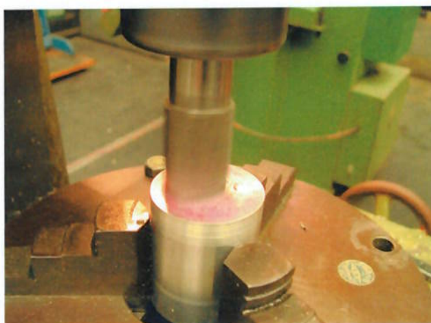
Figura 20 - Furação utilizando a fresadora
